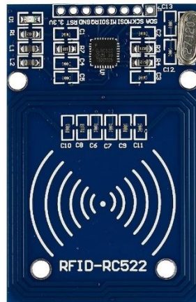
Рис. 1 - Зовнішній вигляд RC522 ArduinoKit
