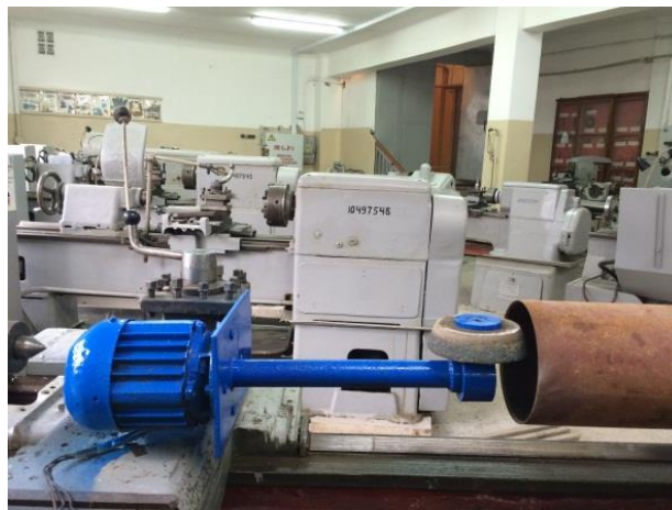
Рис. 1 – Схема обробки шліфуванням отвору у циліндрі
