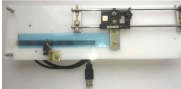
Рис. 2. Загальний вигляд датчика лінійних переміщень на муаровому ефекті
